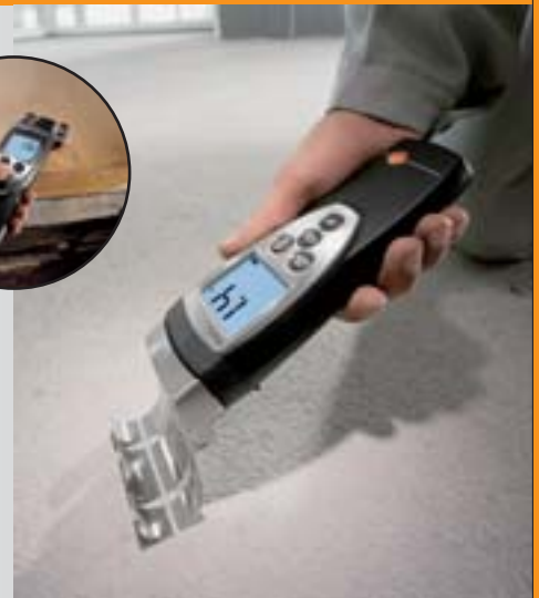
Veloce e semplice - Controllo dell'umidità di rivestimenti. La misurazione di più punti su una superficie garantisce maggiore sicurezza.
