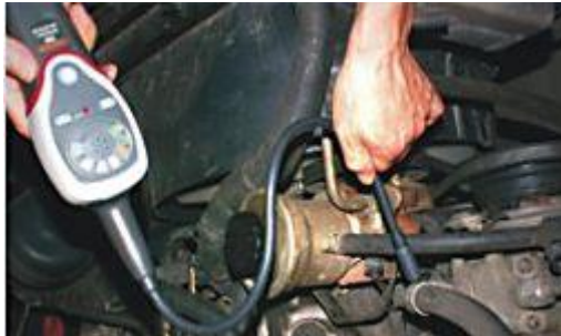
Rilevatore di fughe mentre viene usato in un sistema di aria condizionata
