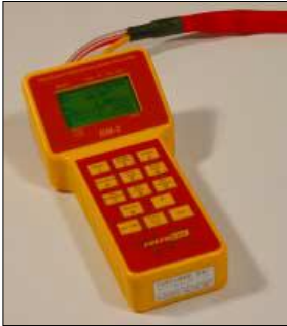
Fig. 3. Manometro digitale per il controllo elettronico della velocità e della pressione.
