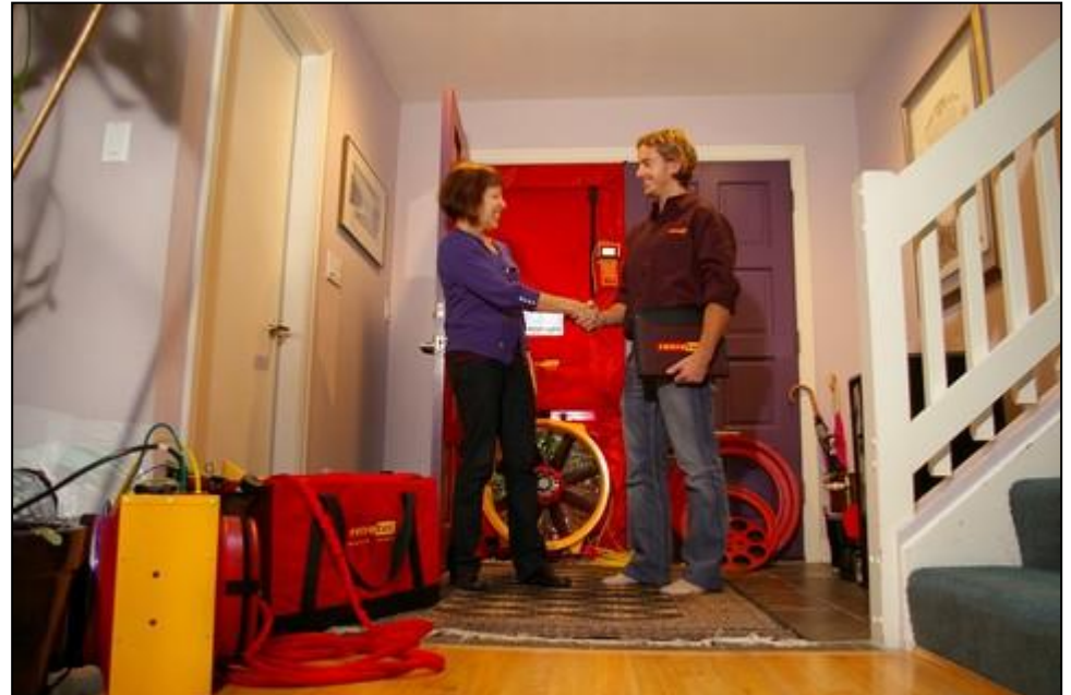
Fig. 4. Esecuzione della prova di blower door test su un edificio residenziale.
