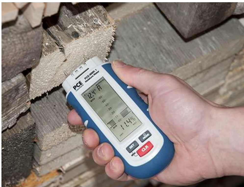
Il misuratore di umidità universale mentre misura con le sonde interne.
