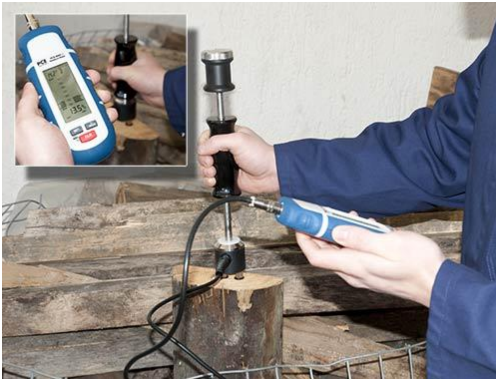
Il misuratore di umidità mentre misura con con l'elettrodo di martelletto
