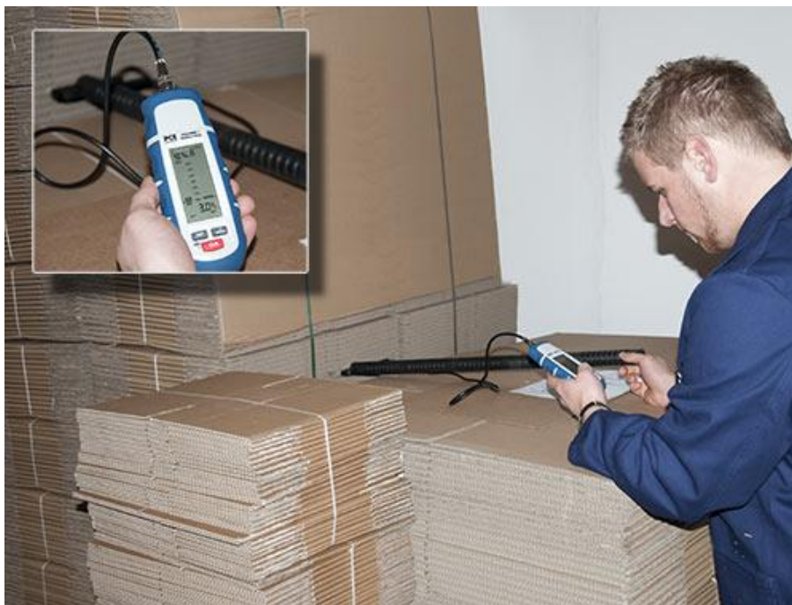
Controllo nell'ingresso delle merci con il misuratore di umidità universale.
