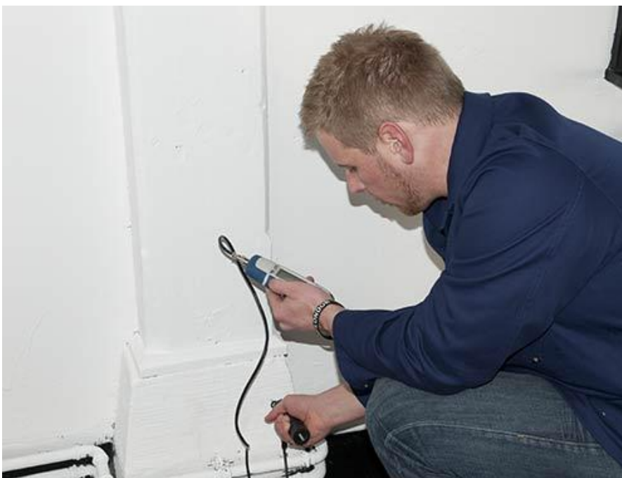
Con il misuratore di umidità universale si possono pianificare le varie fasi del lavoro.
