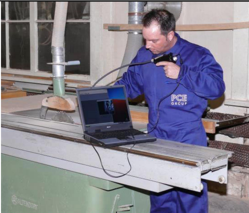
Il tecnico P. Philipp mentre ispeziona la propulsione di una sega circolare.
