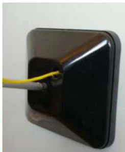
Coperchio a pressione per localizzare le condutture meno permeabili
